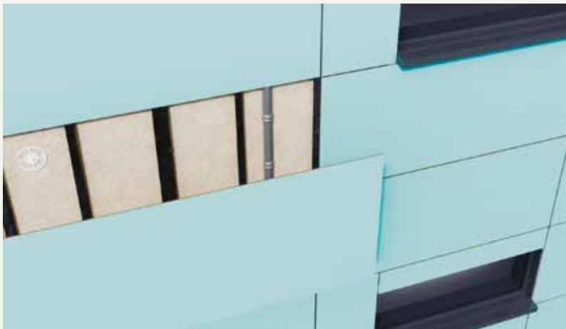
Ventilerade fasadkonstruktioner kan demonteras och separeras i rena delar, vilket gör det möjligt att återanvända dem.
