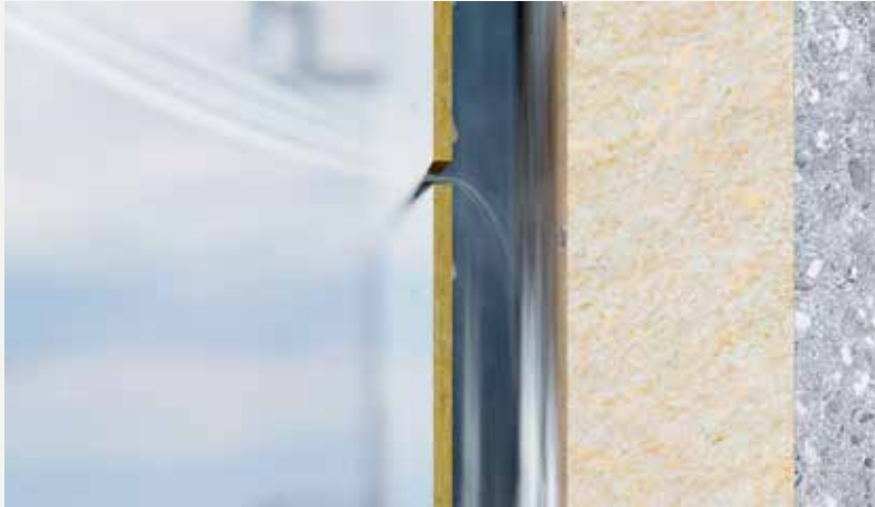
Ventilationseffekten bakom och genom fogen i fasadbeklädnaden
