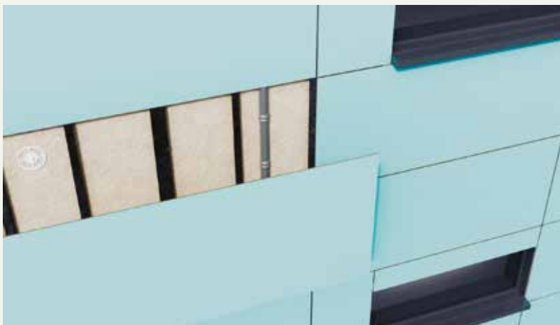
Ventilerede facadekonstruktioner kan afmonteres og adskilles i rene dele, hvilket gør det muligt at genanvende dem.
